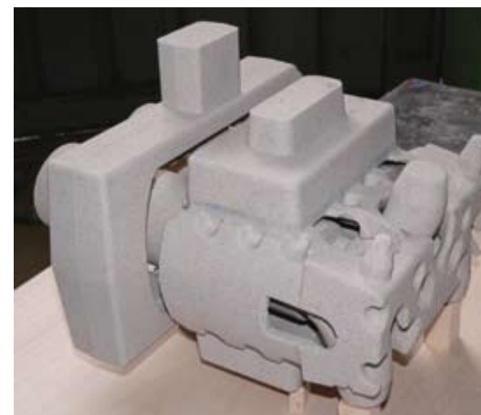
Fig. 4 Ramolaggio di tutte le anime per la fusione di cilindro in ghisa (per un'auto d'epoca).
