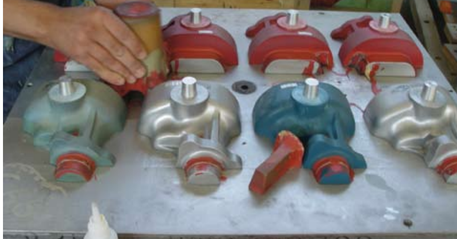
Fig. 7 Fissaggio in placca di modelli (corpo pompa)
